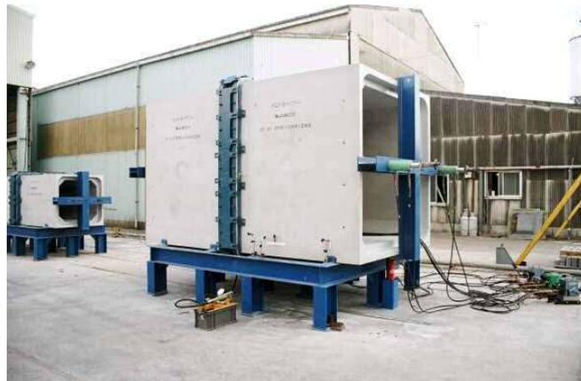
継手部外水圧水密試験状況
