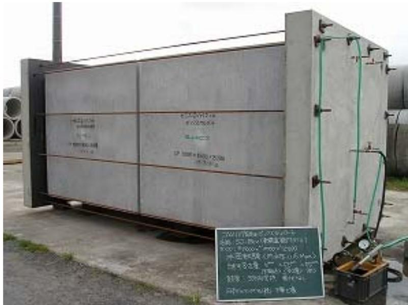
継手部水密(内水圧)試験状況
