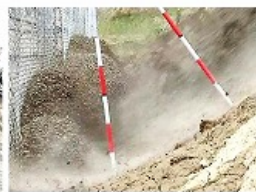
【土砂衝突・全体実物実験】
