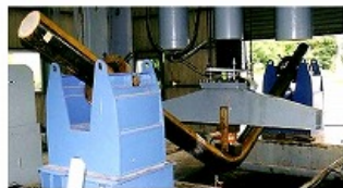
【支柱曲げ実験】
