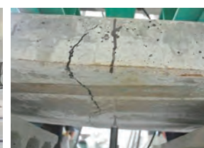
曲げ強度試験(破壊時)
