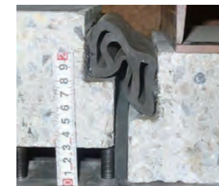
段差変形の状態
