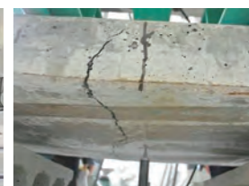
曲げ強度試験(破壊時)
