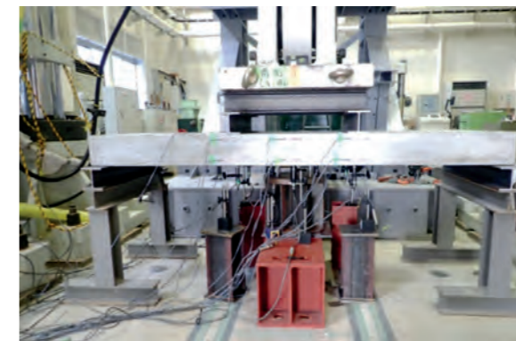
皿ばねの性能確認（RCスラブの二点載荷試験）
