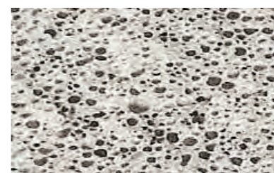
硬化体断面の拡大写真 100 ~ 200ミクロンの気泡が均一に広がっている。
