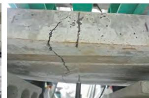
曲げ強度試験（破壊時）
