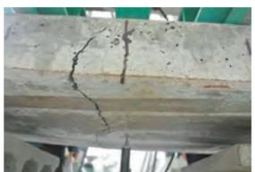
曲げ強度試験(破壊時)
