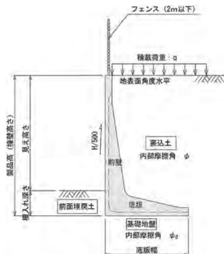
HTタイプ: 比較的良好地盤 裏込め土の内部摩擦角 $\phi \geq 30^\circ$ ※3
