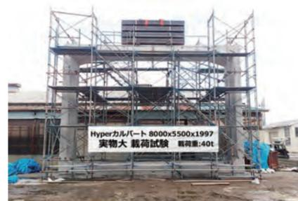
実製品の構造性能を確認するために、名古屋大学大学院 中村光教授指導のもと実物大載荷試験や接合部の部分試験を実施しております。
