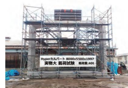
実製品の構造性能を確認するために、名古屋大学大学院 中村光教授指導のもと実物大載荷試験や接合部の部分試験を実施しております。構造体の耐力、及び、接合部の接合状況を確認するため、「コンクリートひずみ」、「鉄筋ひずみ」、「ひび割れ幅」、「部材変位」、「接合部変位」を計測しています。設計値と比較しても、十分な耐力を有することを確認しています。
