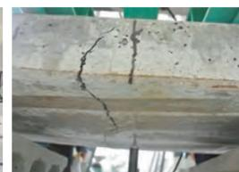
曲げ強度試験(破壊時)
