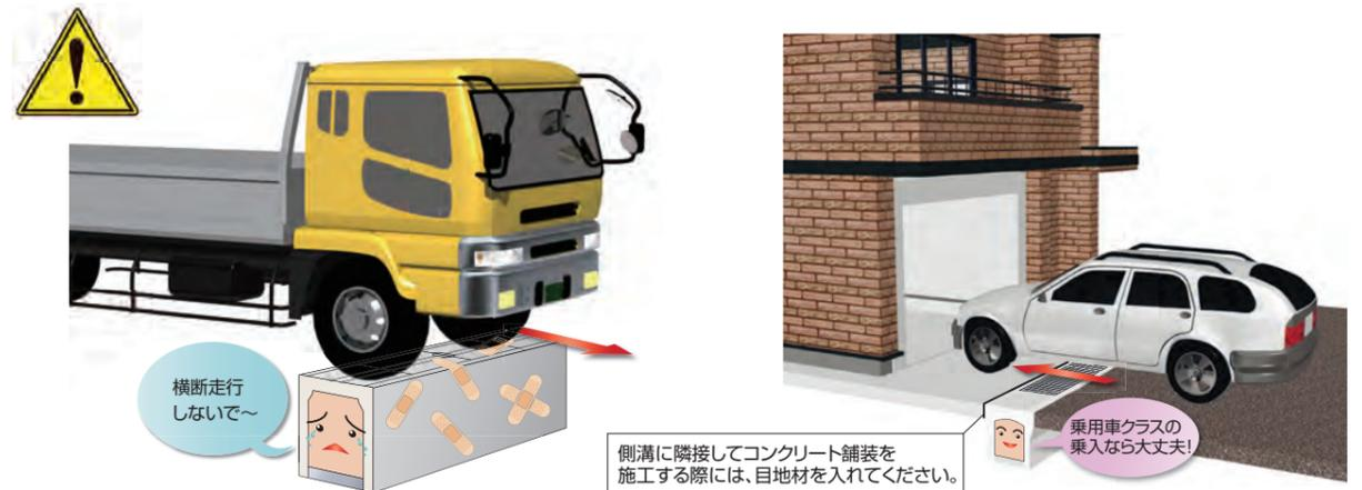
側溝に隣接してコンクリート舗装を施工する際には、目地材を入れてください。
