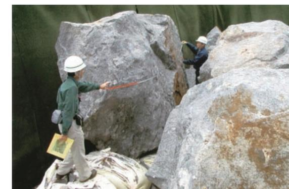
衝突した落石の計測 1.5×2.5×3.5m
