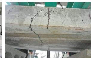
曲げ強度試験（破壊時）
