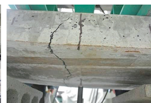
曲げ強度試験（破壊時）
