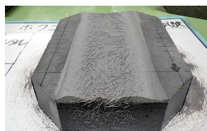
HSモルタル20時間経過後
