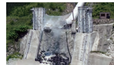
重錘衝突実験(推定最大変形時)
