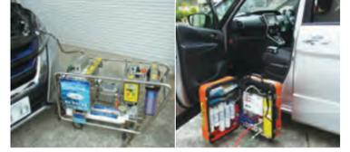
省電力なので、インバーター（市販品）を使用することで、乗用車バッテリーでも稼働できます。
