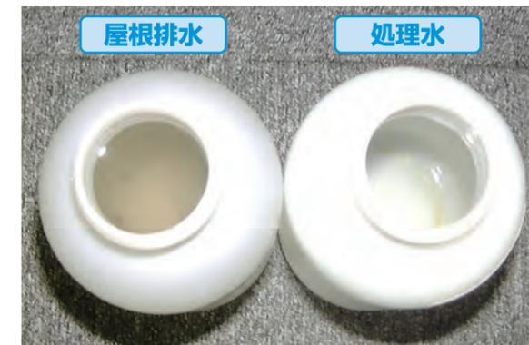
左は、一般住宅の屋根から雨樋をつたってきた雨水とそれを「れいんクル」で処理した水の比較写真です。屋根排水は屋根や雨樋に溜まった、ゴミ、粉塵、鳥のふん等の汚濁物が雨水とともに流れ出ており、想像以上に汚れています。雨水をより安全に利用するために、「れいんクル」の活用を提案します。
