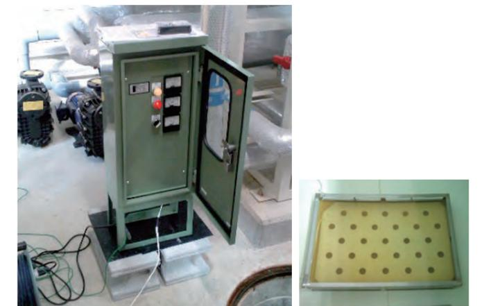
電子部品のメッキ工場では純水を使用していますが、純水の水質（白カビ発生）が原因と考えられる品質トラブルが発生していました。純水タンクにクリーンアクアを設置したところ、水質が改善され不良が減りました。また、イオン交換樹脂による純水採水量が増加しコストダウンが図れ、メッキ品質の向上も確認できました。
