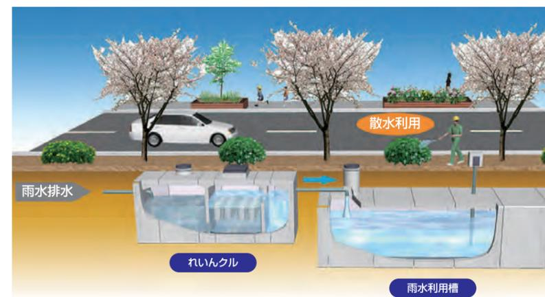
降雨時の路面排水を『れいんクル』により浄化、貯留し、街路樹や植樹帯への散水用水として利用します。
