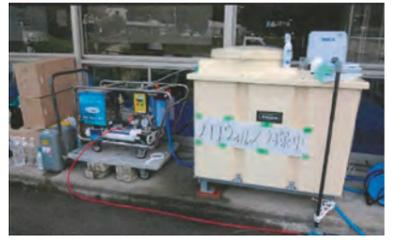
ノロウイルス対策として、浄化水の次亜塩素濃度を簡単に調整できる機能により、衛生管理用の「殺菌水」を1.6t/日製造し、集団感染防御にご使用いただきました。
