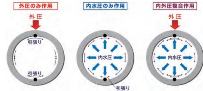
内外圧組合せ荷重のメカニズム
