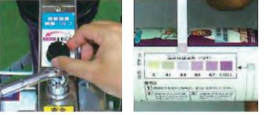
自動塩素注入のつまみを回し塩素濃度を調整します。付属の塩素チェッカーで塩素濃度を確認します。
