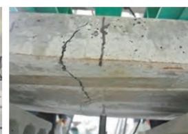
曲げ強度試験(破壊時)
