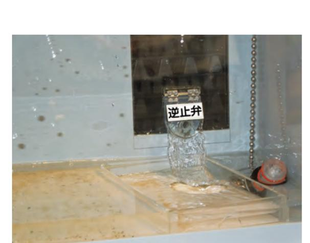
逆止弁からの放流状況 (1次貯留槽の水位降下後)
