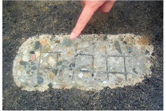
切削(t=5mm)付着強度:適合
