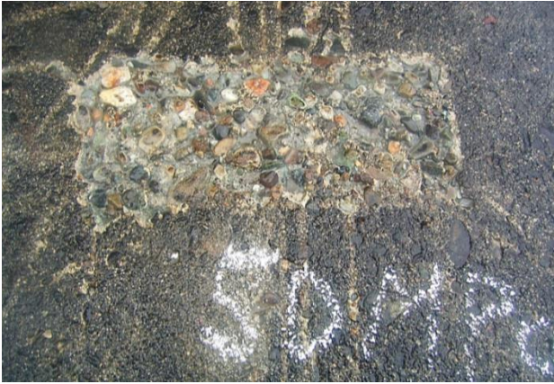
高压洗净(50MPa)付着強度:不適合
