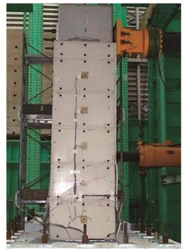
曲げ破壊実験
