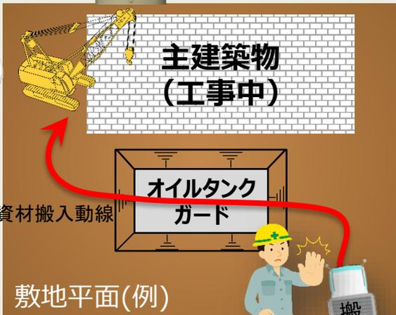
敷地平面(例) 車両の搬入規制による主建築物工事の遅延を最小限に抑えます。
