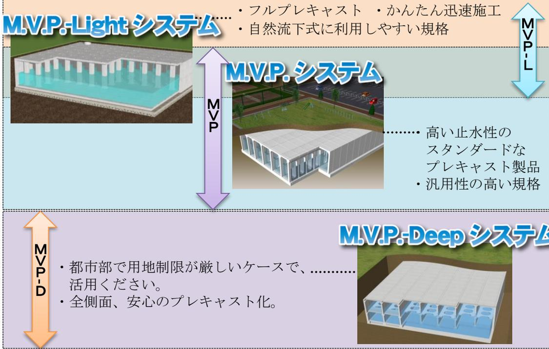
・底版は、あえて現場打ち（M.V.P, M.V.P.-D）※メンテナンス機能のため
