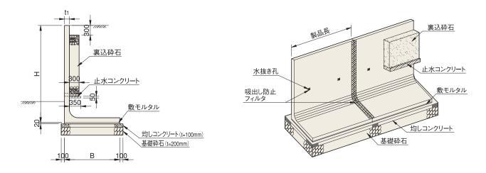
▶適用範囲:プレキャストL型擁壁の施工に適します
