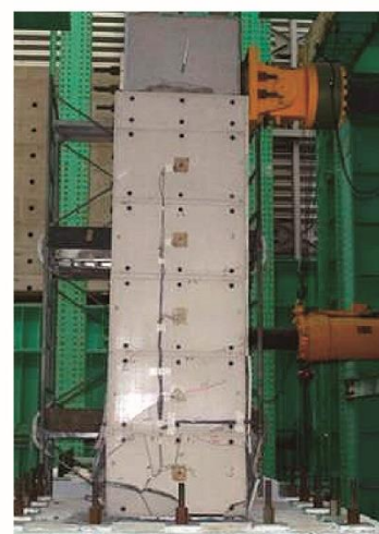
曲げ破壊実験
