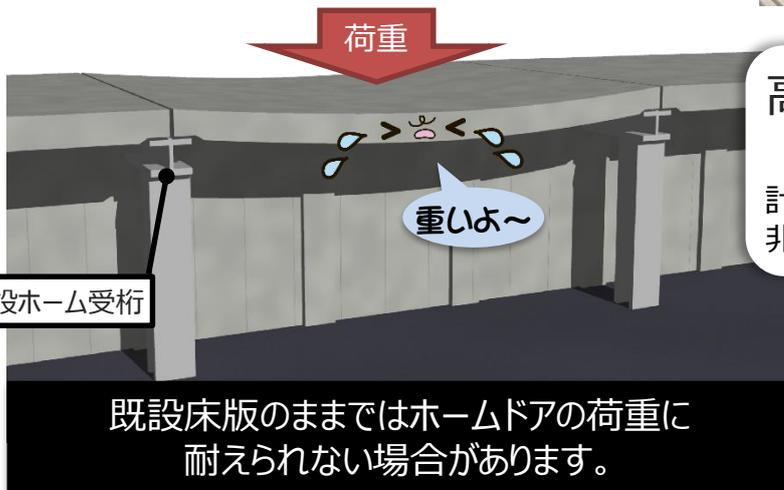
高強度コンクリート(ductal)製の床版に置き換えて解決！
