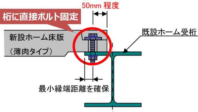
架設後は床版上より受桁に削孔機で穴をあけ、ボルトを挿入し、締め付けて固定完了となります。
