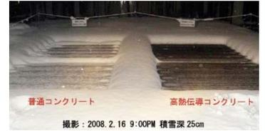
熱伝導率の高い（通常の2倍）珪石コンクリートを使用しています。
