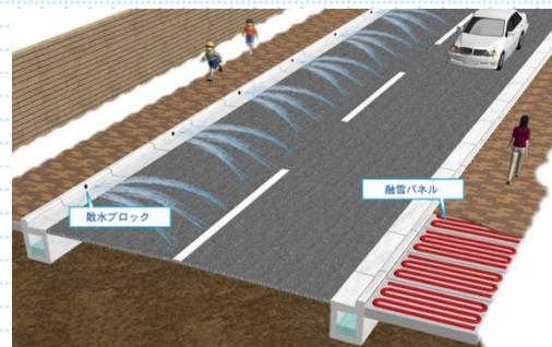
※独自の散水ノズルをL型側溝や縁石に埋め込んでいます。
