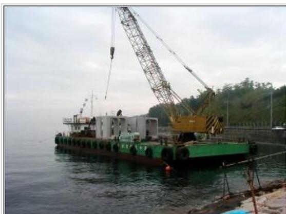
地上からBOX運搬できない場合は港にてクレーン船に積替えて施工します。
