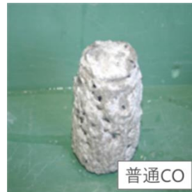
5%硫酸水溶液 浸漬試験 (浸漬期間 56日)
